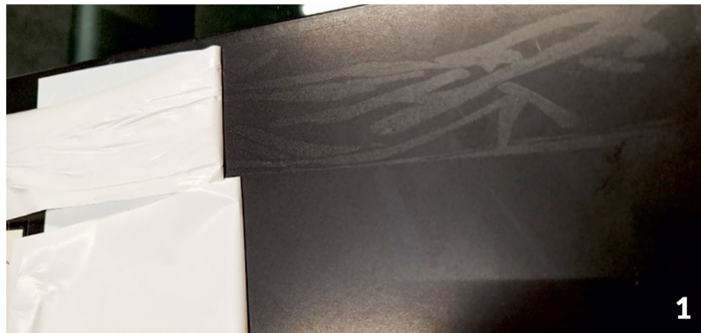
1: Die Prüfstücke weisen Kleberückstände nach dem Klimawechseltest auf. Foto: VOA
