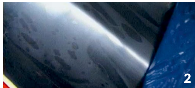
1: Die Prüfstücke weisen Kleberückstände nach dem Klimawechseltest auf. Foto: VOA
