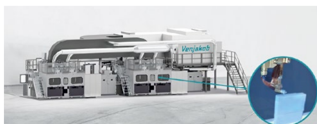
Batteriezellenbeschichtungslinie inkl. Vorbehandlung und Härtung des 100 % UV-Lackes.
