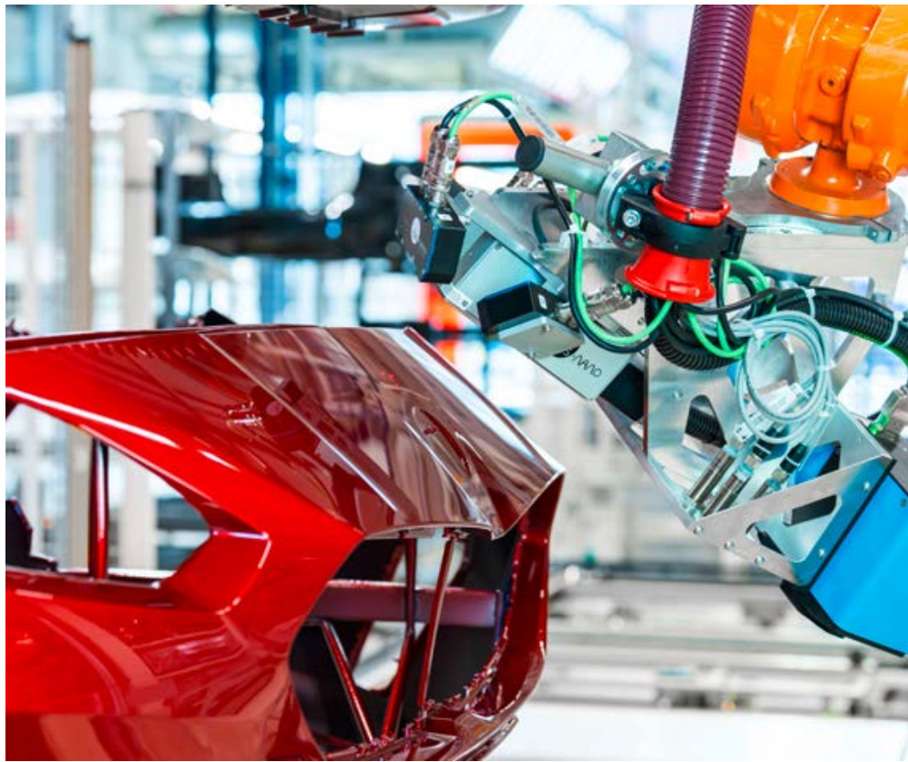
Zerstörungsfrei und hochpräzise: Das robotergeführte Terahertz-Messsystem prüft Lackschichtdicken an Kunststoffbauteilen auf einen Mikrometer genau.
