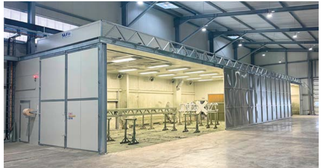
Die neuen Spritz- und Trockenkabinen ermöglichen eine große Flexibilität im Lackierprozess.
