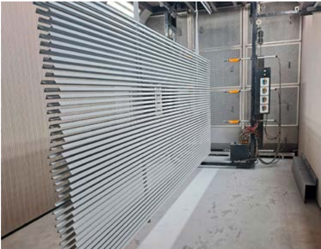
Mit dem Einsatz des "Jumbo-Coater" senkt Colour-Line die Bearbeitungszeit pro Warenträger um bis zu 70 %, von rund 20 auf bestenfalls sechs Minuten.
