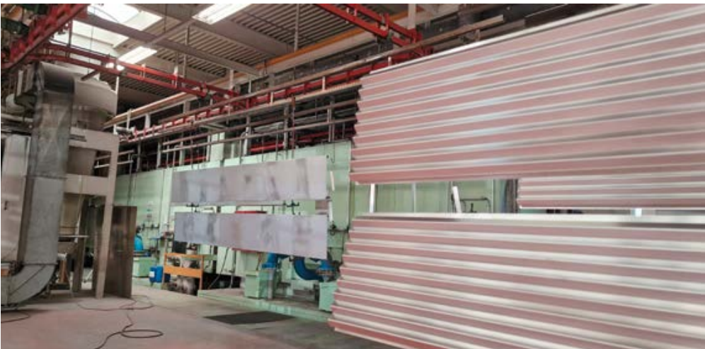
Zacken-Fassadenelemente auf dem Weg zur Vorbehandlung.
