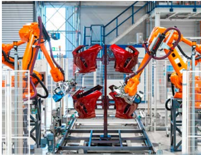
Übersicht der Messzelle: Zwei Roboter in der End-of-Line-Messzelle übernehmen die automatisierte, zerstörungsfreie Schichtdickenmessung im laufenden Serienprozess. Fotos: BMW
