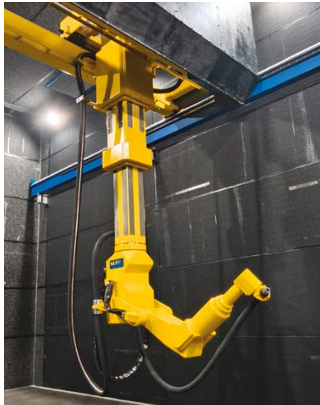
Der neue Strahlroboter im Freistrahlaum erlaubt die automatisierte mechanische Vorbehandlung. Fotos: SLF
