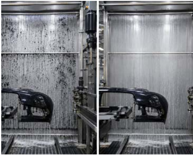
Der Vergleich zeigt den Effekt einer Grundreinigung: Verschmutzungen und Prozessrückstände werden entfernt, potenzielle Fehlerquellen reduziert. Foto: KI generiert
